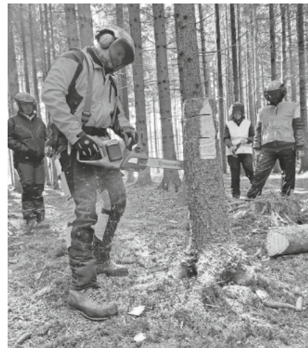
Im Auffrischungslehrgang lernen die Teilnehmenden unter anderem die Schnittführung mit der Motorsäge. Foto: Landratsamt
